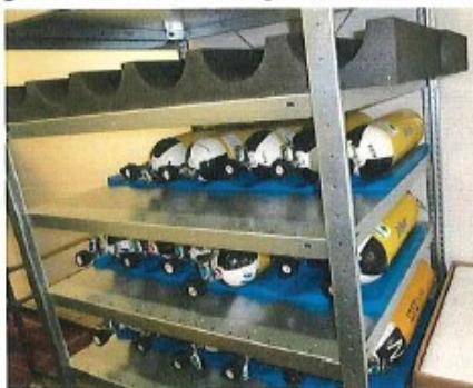
Regale nicht ausreichend standsicher, Ablage und Entnahme nicht sicher, Propangasflasche ohne Schutzkappe (s. Pkt. 2.15)
