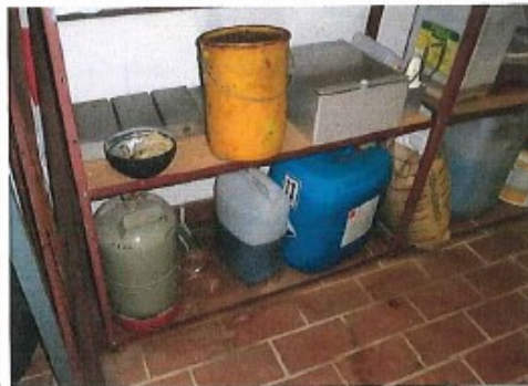
Regale nicht ausreichend standsicher, Ablage und Entnahme nicht sicher, Propangasflasche ohne Schutzkappe (s. Pkt. 2.15)
