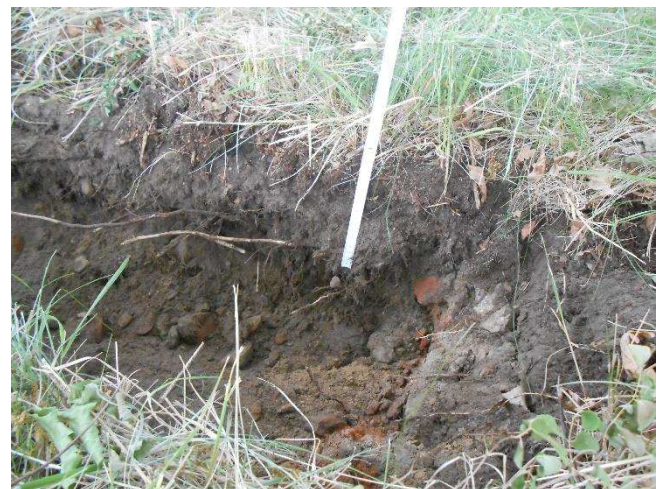
Abb.4: Aufmaße; deutlich sichtbar der humose Oberboden und Ziegelbruch
