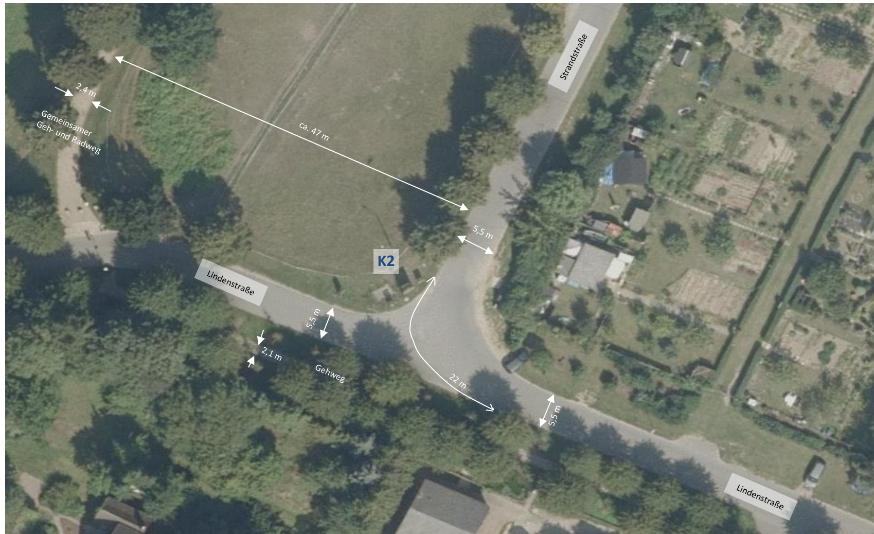
Abbildung 3: Fahrbahn- und Gehwegbreiten am Knoten K2 (Karten auf Grundlage von GeoPortal.MV [2])
