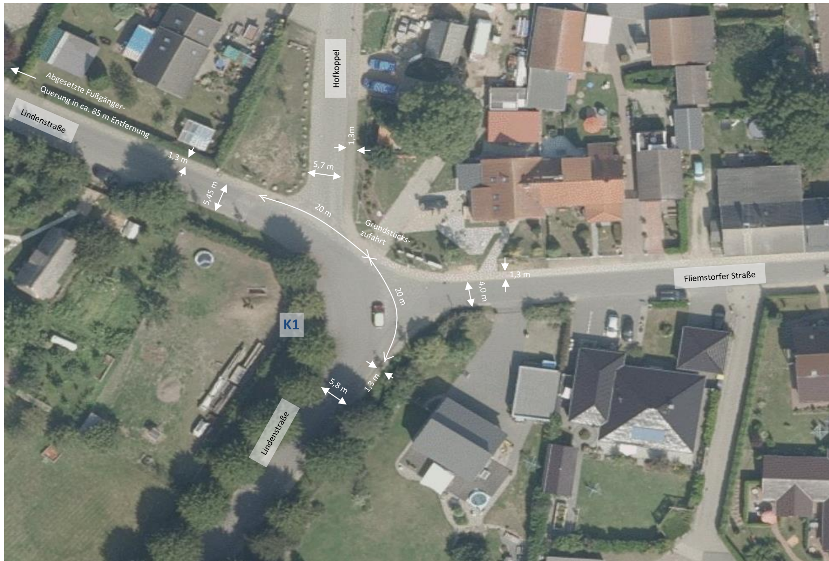
Abbildung 2: Fahrbahn- und Gehwegbreiten am Knoten K1 (Karten auf Grundlage von GeoPortal.MV [2])
