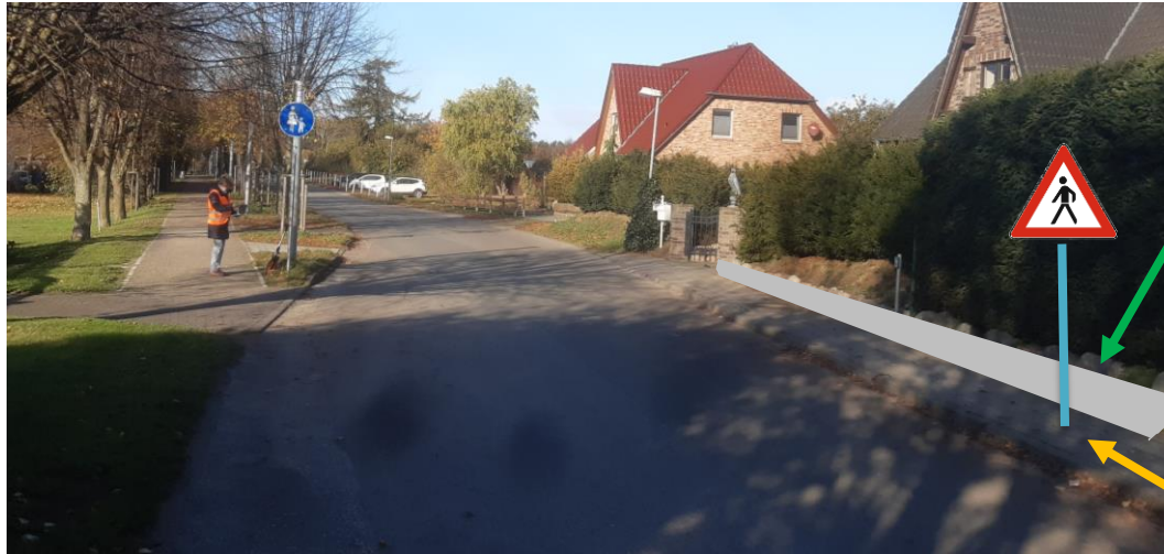
Abbildung 17: Maßnahmen Knotenzwischenbereich: Beschilderung Fußgängerquerung
