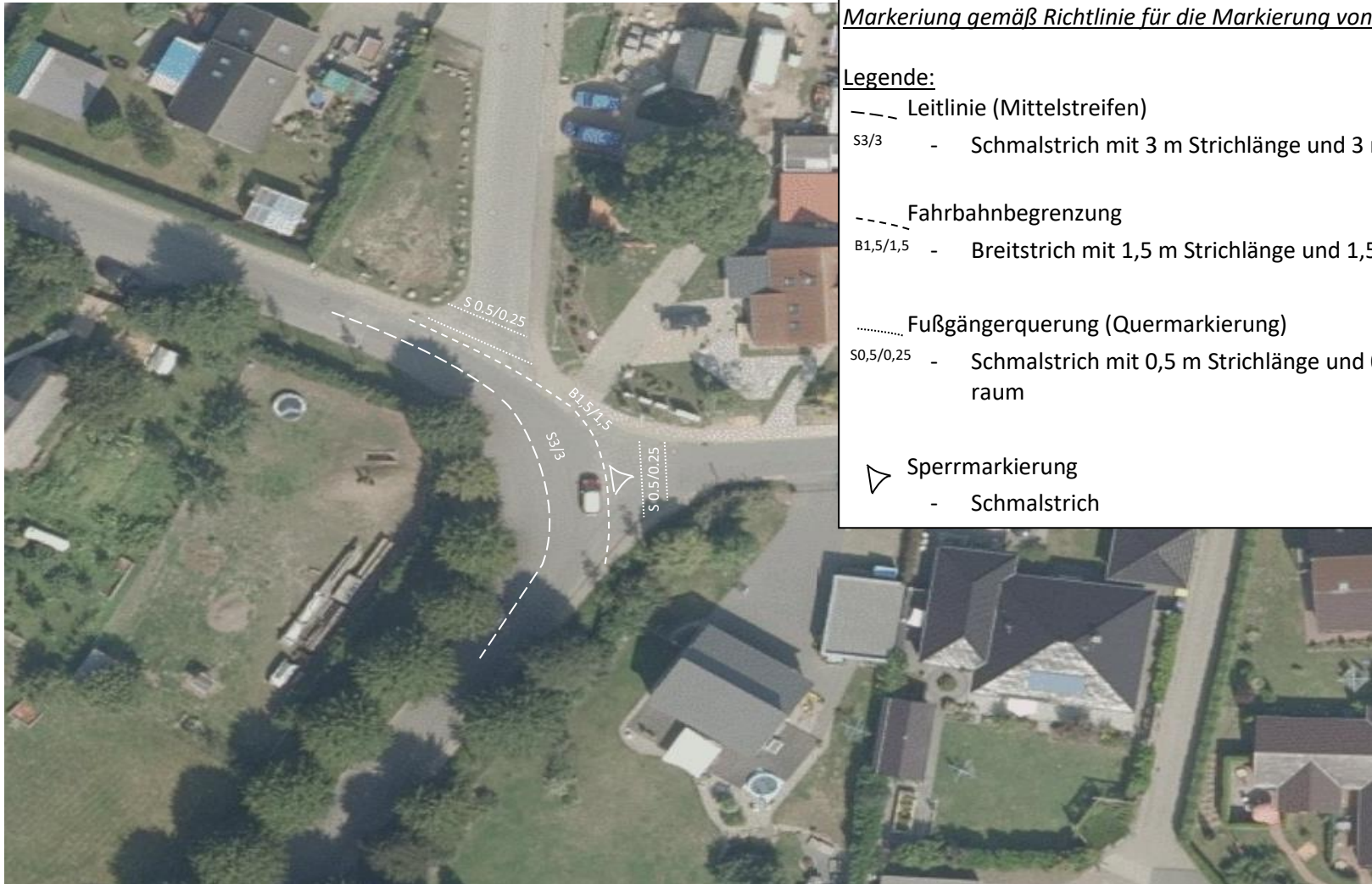
Abbildung 13: Maßnahmen Knoten 1: Fahrbahnmarkierung (Karten auf Grundlage von GeoPortal.MV [2])
