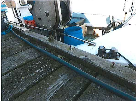
KLWI901_A_2019H_L-BORDBRETT F-18 SCHRAUBEN HERAUSSTEHEND
