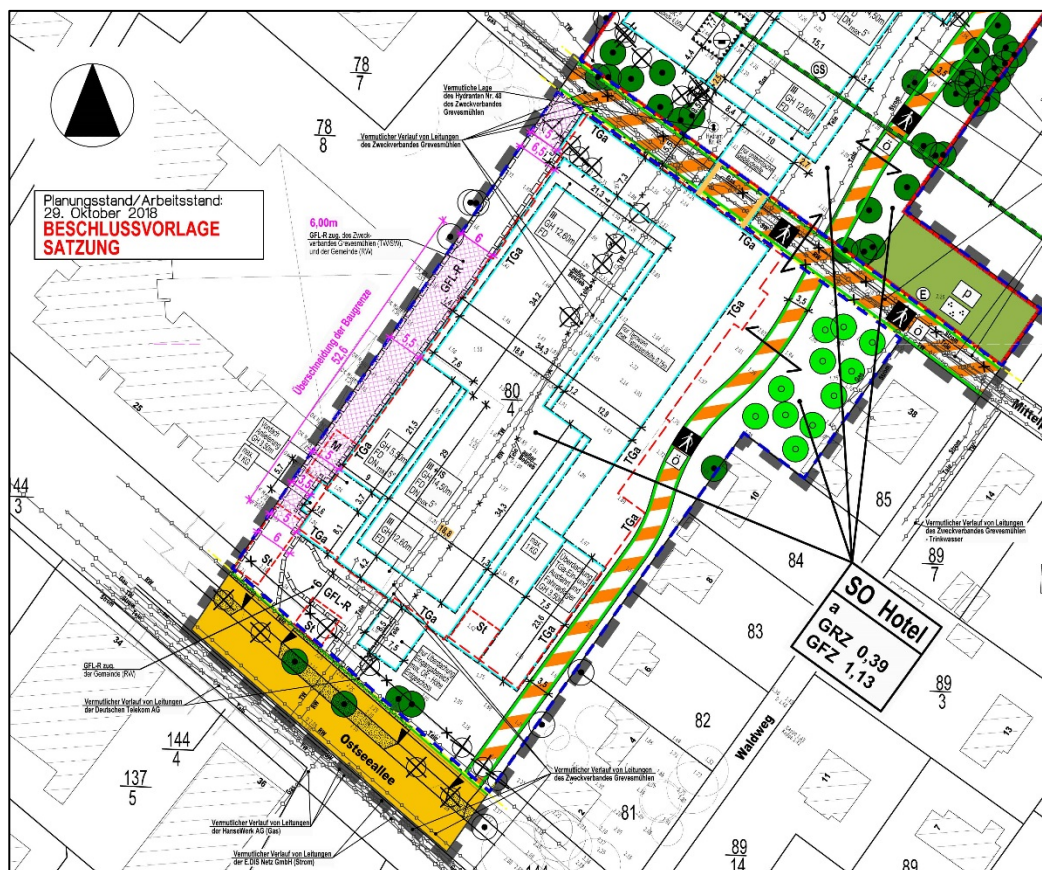
Abb. 13: Schutzstreifen für die Leitungen mit Kennzeichnung von Bereichen mit einer Breite von weniger als 6,00 m (pink schraffiert)
