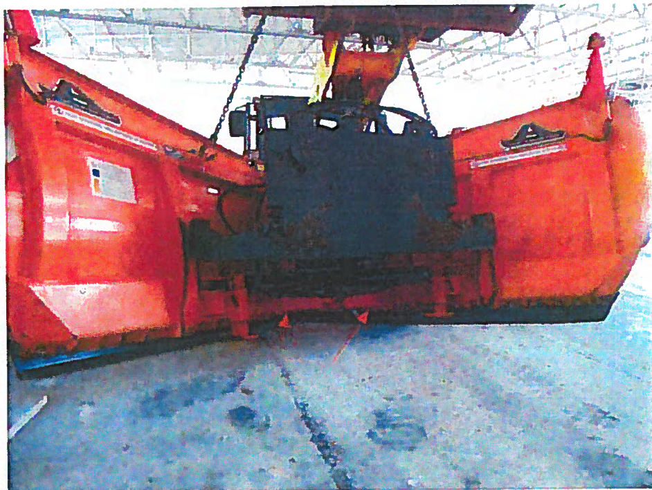
Bild 2 : Übersicht von hinten Verstärkungen im unteren Bereich
