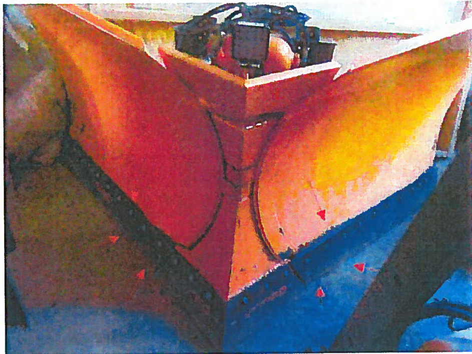
Bild 1 : Übersicht - Y 6 Keilschneepflug mit veränderbarer Form Schadenbereich - Scharflügel im unteren, doppelwandigen Bereich und Schürfleisten gestaucht und stark verzogen
