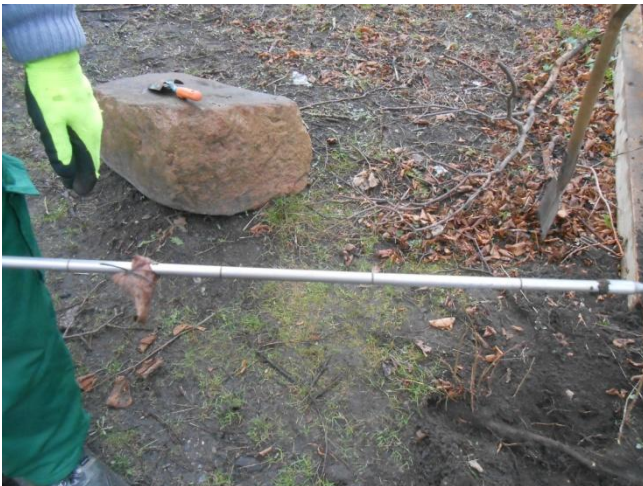
Abb.3: Sichtgrabung und Sondierung, Einstichtiefe im Boden: max. 35 cm, sonst Schotter, Bruch
