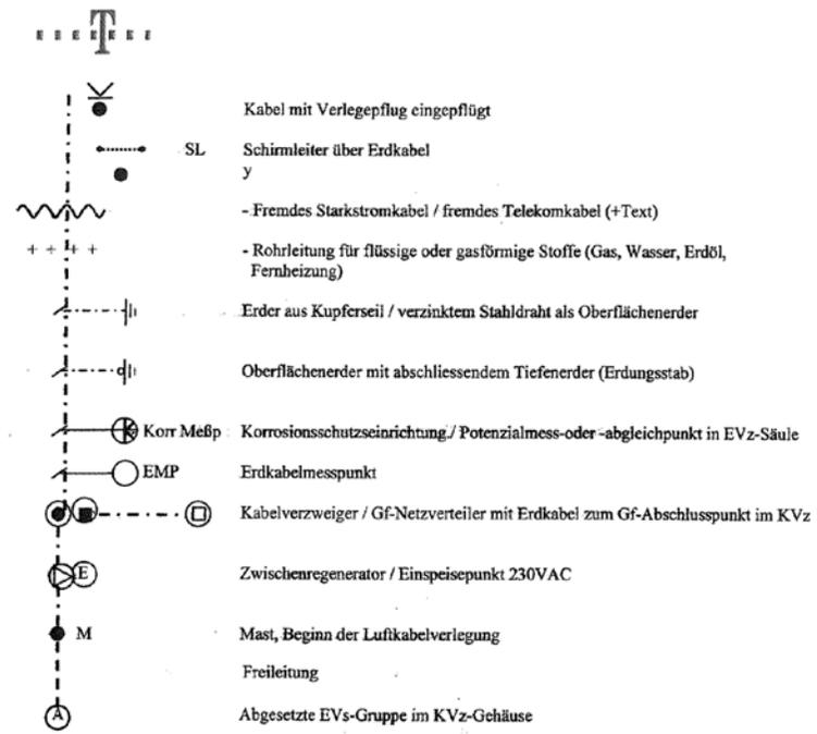
Lediglich die in den Plänen vermerkten Maße (nicht die zeichnerische Darstellung!) geben einen Anhalt für die Lage der dargestellten Telekommunikationsanlagen. Einmessungen an Kabelkanälen beziehen sich auf die Mitte der Abdeckung (Deckel). Alle Maße sind in Meter vermerkt.
