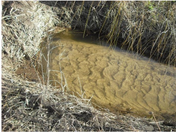
Abbildung 3-6: Sandige Sedimentablagerungen zwischen Station 1+403 und 1+039 bei Fließgeschwindigkeiten zwischen 0,6 – 0,1 m/s
