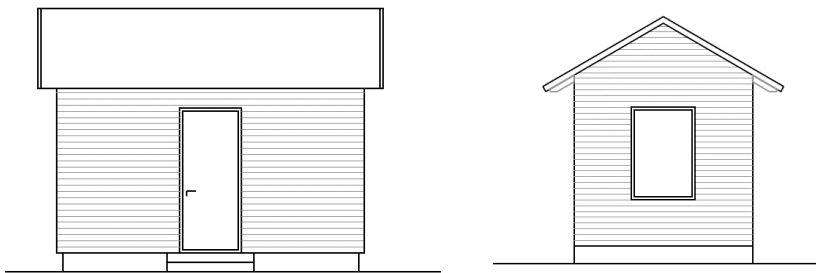
Verschalung Horizontal, 30° Dachneigung
