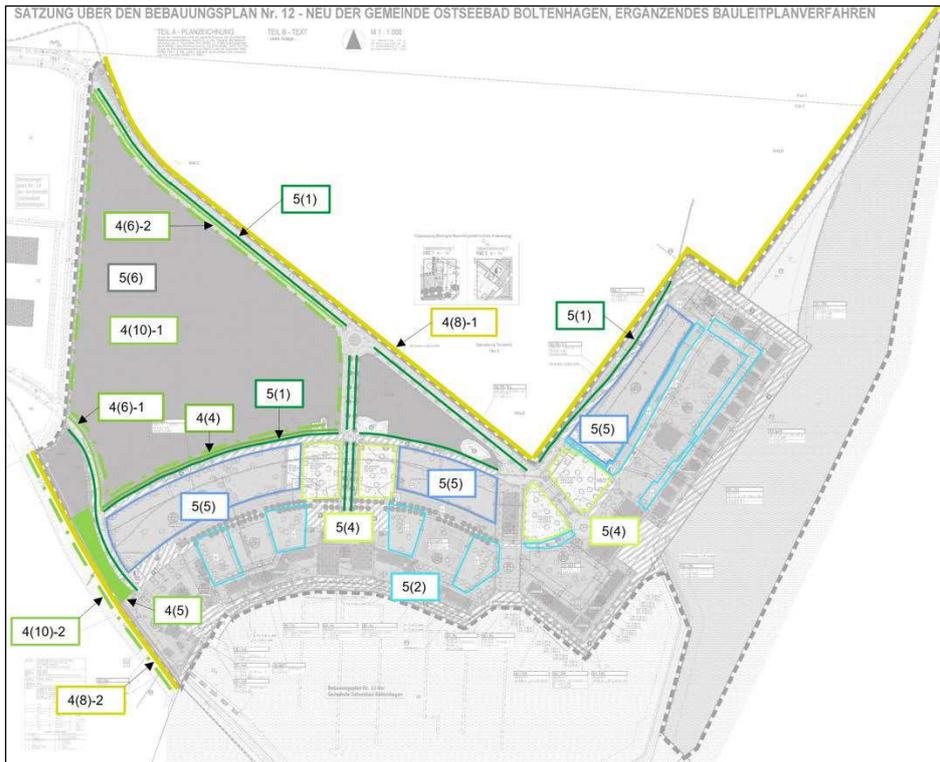
Abb. 22: Kennzeichnung der Maßnahmen auf dem Lageplan gemäß Text, Teil B
