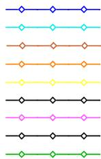
Vermutlicher Verlauf von Leitungen, unterirdisch;
