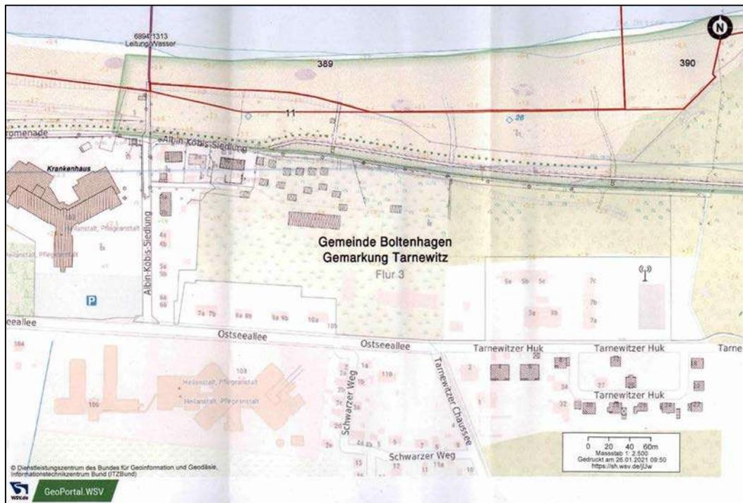
Abb. 5: Lage der strom- und schifffahrtspolizeilich genehmigten Wasser-/ Entnahmeleitung, Quelle: Stellungnahme des Wasserstraßen- und Schifffahrtsamtes Ostsee vom 26.01.2021)
