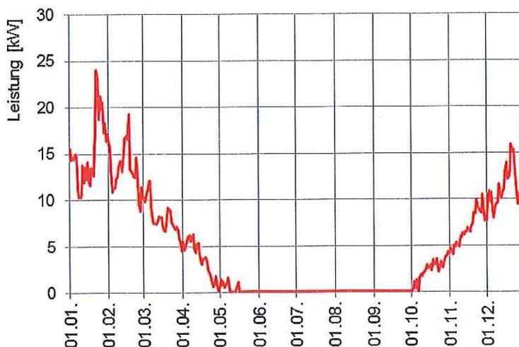
Abbildung 19: Jahresgang Wärmebedarf Feuerwehr (Typjahr)
