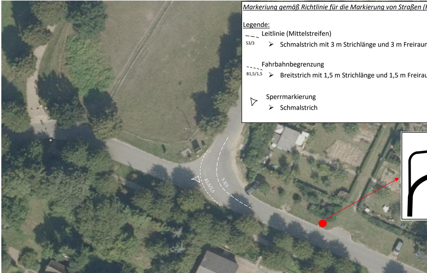
Abbildung 14: Maßnahmen Knoten 2: Fahrbahnmarkierung und Beschilderung (Karten auf Grundlage von GeoPortal.MV [2])
